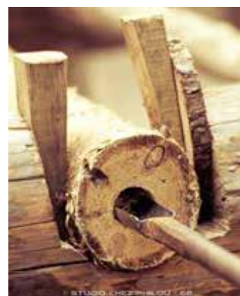
La fabrication et le perçage de canalisations en bois (Musée du Bois de Labaroche)
