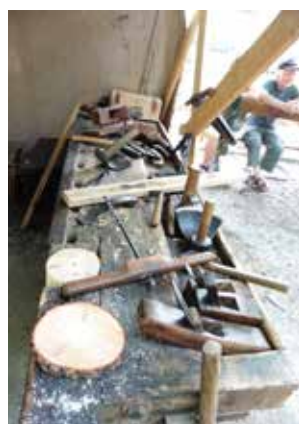
La fabrication et le perçage de canalisations en bois (Musée du Bois de Labaroche)
