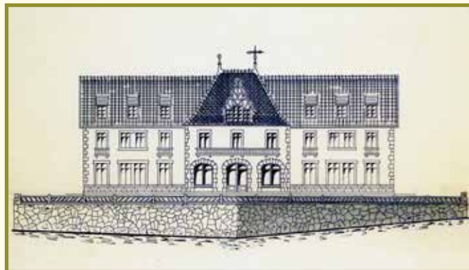
Plan du projet : l'immeuble est imposant, d'une dimension de 35 m sur 12 m avec une hauteur totale de 14 m.
