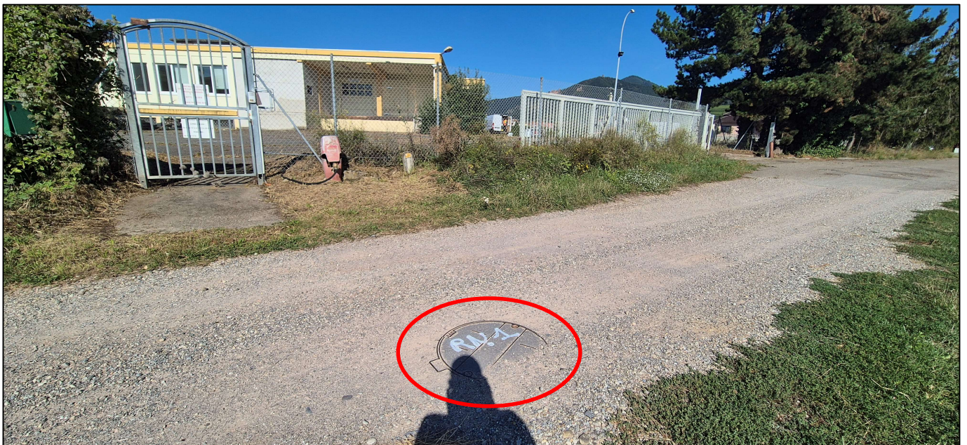
Figure 11 : Implantation et photographie du repère topographique utilisé
