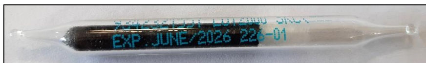
Figure 53 : Photographie du support de prélèvement à charbon actif (Hydrocarbures, COHV, BTEX, Naphtalène) – ECR Environnement
