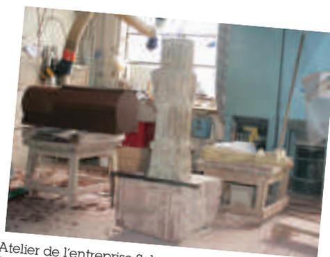
Atelier de l'entreprise Scherberich : remplacement à l'identique du fût central. L'ancien est irréparable, le grès étant fragilisé par de multiples fentes et morceaux manquants.
