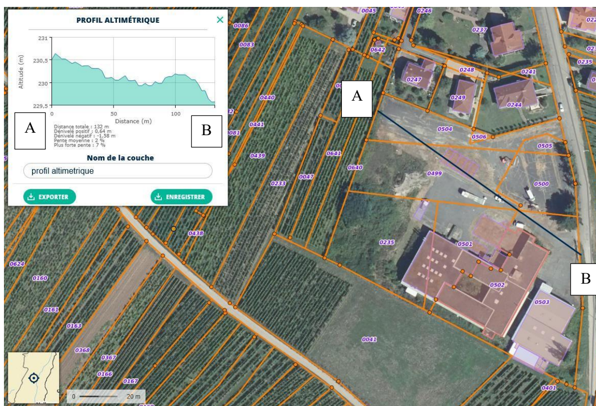
Figure 1 : Profil altimétrique de la zone UBf
